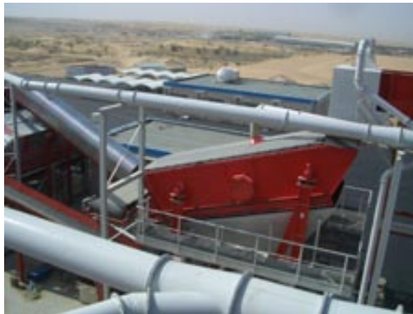
BIVITEC screening machine supplied by Binder; in the background: composting plant and tyre shredder BIVITEC-Siebmaschine der Fa. Binder; im Hintergrund Kompostierungs- und Reifenzerkleinerungsanlage
