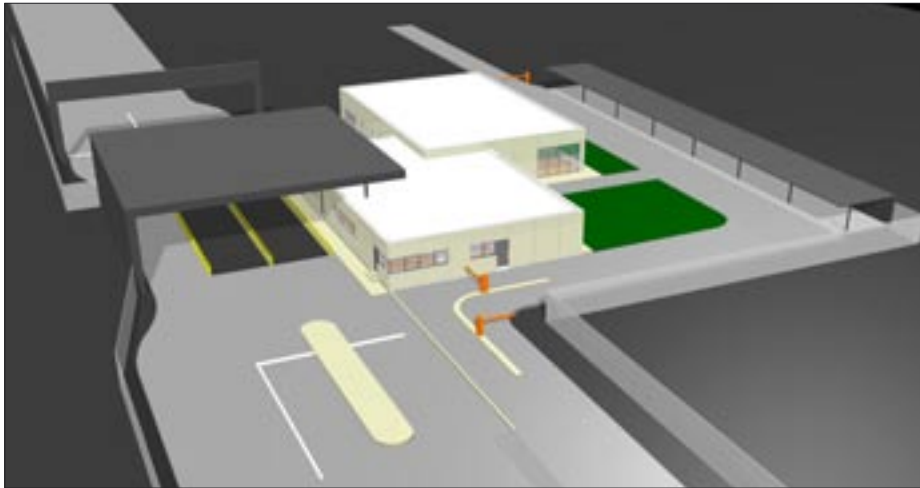
The new entrance and office area with two integrated weigh bridges, automatic truck identification and digital display panel Neuer Einfahrts- und Bürobereich mit zwei Brückenwaagen, automatischer LKW-Erkennung und digitale Anzeigentafel
